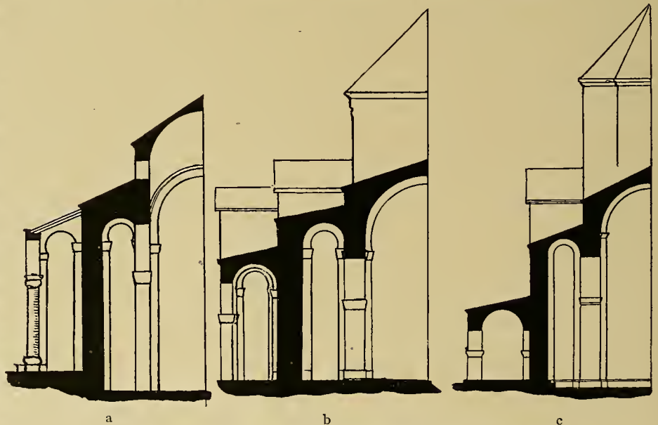
Abb. 423—425. Ableitung des Seitenschubs durch den Umgang.
