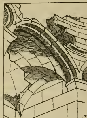
Abb. 342. Irind, Achtpaß: Kreuzgewölbe des Eingangsraumes.
